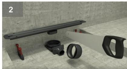
Соедините все элементы трапа. Можно уменьшить редуктор под необходимый размер путем поперечного распила.
